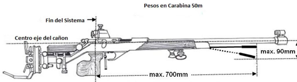
Los pesos en el extremo de la culata de la carabina no pueden extenderse mas de 90 mm por debajo de la línea central del cañón, ni mas de 700 mm hacia adelante desde la parte posterior (trasera) del sistema
